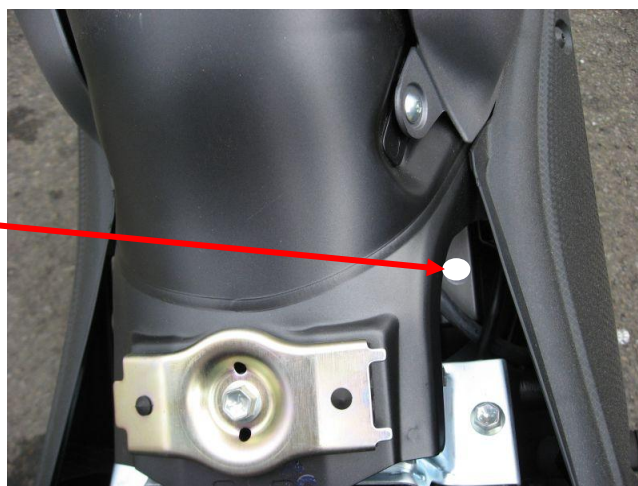
AN650Z 前置物箱左側檢修蓋內，車台管貼上白色貼
