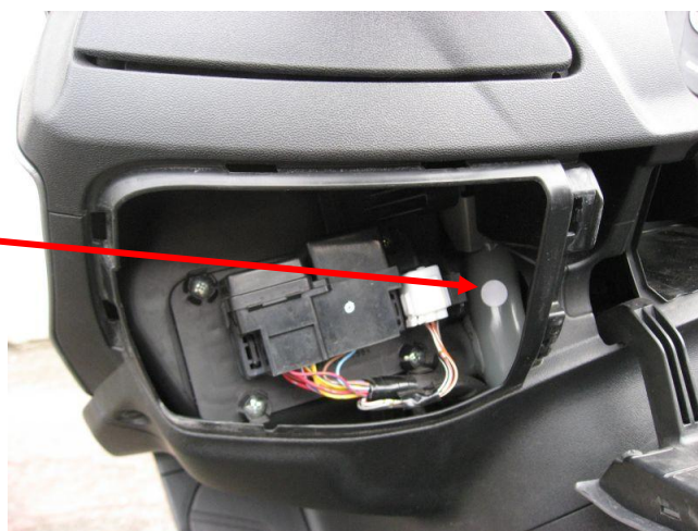
AN650Z 前置物箱左側檢修蓋內，車台管貼上白色貼
