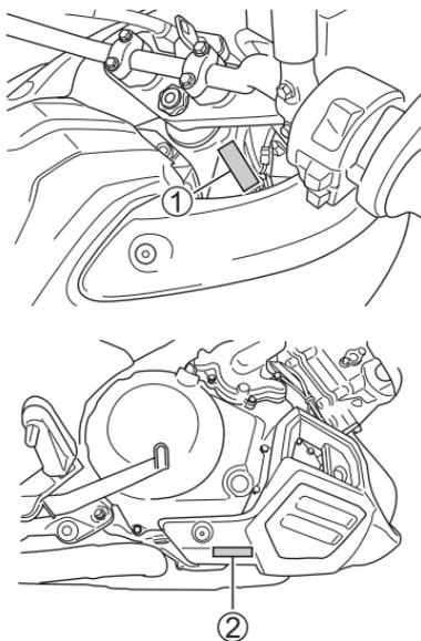
在機車登錄時需要使用車架及/或引擎的序號。在訂購零件或索取特殊維修資訊時，這些號碼也能協助您的經銷商處理相關事務。車架號碼 ① 打刻在轉向桿上。引擎號碼 ② 打刻在曲軸箱體上。
