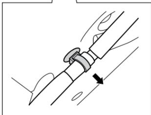
7. 拆下左右油箱側保護蓋螺栓。拆下線路固定夾。
