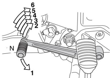
此車型使用六檔變速箱，其運作方式如圖所示。若要正確換擋，請在操作腳踏換檔桿時，握緊離合器拉桿並關閉油門。勾起腳踏換檔桿可升檔，壓腳踏換檔桿可降檔。空檔位於 1、2 檔之間。需要打空檔時，請將換檔桿踩升到 1、2 檔之間。
