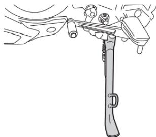
當側站架處於放下狀態且變速箱不在空檔時，內置的連鎖開關會切斷點火線路。
