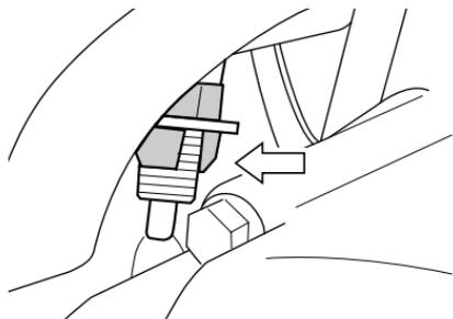
若要調整剎車燈開關，請抬高或降低剎車燈開關，使剎車燈在踩下剎車踏板剛要感應到壓力升高之前亮起。
