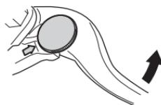
油門轉把和剎車拉桿之間的距離可分 5 個階段調節。
