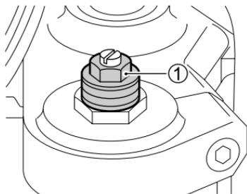
若要變更彈簧預緊量，請將調節器 ① 朝順時針或逆時針轉。將調節器順時針轉可增加彈簧預緊量。將調節器逆時針轉可減少彈簧預緊量。調節器 ① 側邊有 5 條溝線可供參考。位置 5 的彈簧預緊量最小，位置 0 的預緊量最大。本型機車出廠時調節器位於位置 4 上。
