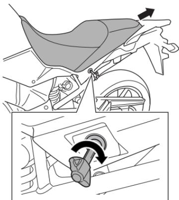
若要打開座墊，請將點火鎖匙插入鎖孔並順時針旋轉。拉起座墊後端並將其向後滑動。
