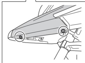
3. 拆下左右螺栓。卸除扣鉤，並拆下左右側外罩 ①。
