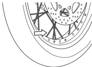
檢查輻條張力以確定輻條接頭的緊密度。您可以用小金屬棒敲打輻條來檢查張力。如果輻條接頭鬆脫，會發出沉重的聲音。
