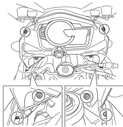
1. 拆下螺栓與緊固器。
