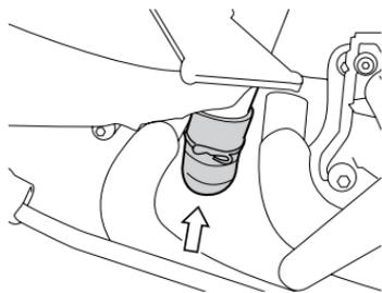
請在進行定期保養時，拆卸洩漏塞以清除水和油。洩漏塞位於空氣濾清器的下面。
