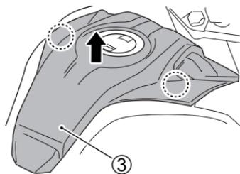
6. 卸離扣鉤，並拆下前箱蓋 ③。蓋子在打圈部位有鉤子。
