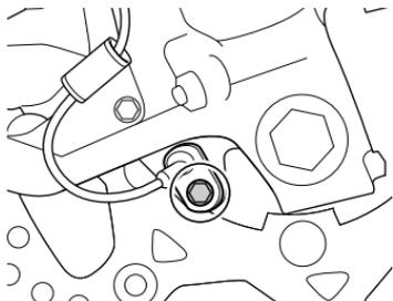
2. 拆下安裝螺栓以卸除前輪速度感知器。
