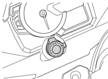
DL1000A/XA 配備可加裝 12V 電氣附件的輸出端子。電氣附件總瓦特數應低於 36W。將附件加裝到輸出端子前，請檢查電氣附件電壓和瓦特數。
