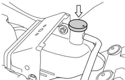
2. 拆下加液蓋，經由加液孔倒入指定的引擎冷卻液，直到液位達到刻線“F”位置。請參閱“建議的燃油、機油和冷卻液”一節。
