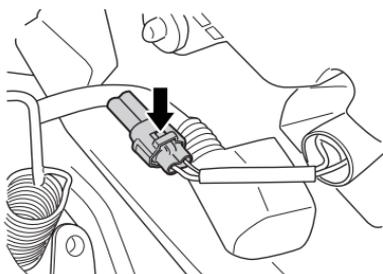
5. 拆卸電源耦合器。 拆下儀錶板總成。
