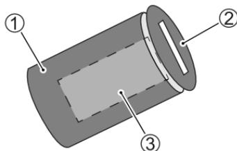
鎖具 ① 附有蓋板 ②，以防止竄改。轉動鎖匙孔蓋以蓋住鎖匙孔 ③，以免異物進入鎖匙孔。若要轉動蓋板，請將鎖匙尖端稍微插入蓋板並旋轉。
