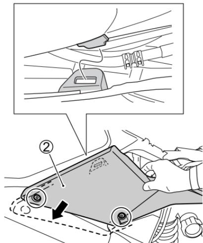
4. 拆下螺栓。拉動左右側車罩 ②。
