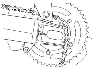
7. 將車輪朝前移動，自扣鏈齒盤卸下驅動鏈。
