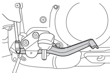
踩下後剎車踏板時將會啟動後碟刹。使用後剎車時，剎車燈會亮起。
