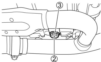
3. 從引擎下方拆下洩油螺栓 ② 和墊片 ③，將機油排入剩油接盤。
