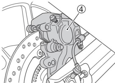
8. 拆下後剎車夾鉗總成 ④。
