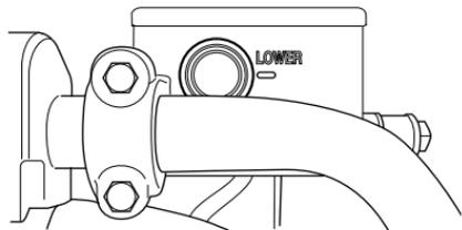
本機車的離合器釋放裝置由液壓運作。不需調整離合器釋放系統，因為系統會自我調節。但是，每次騎乘前，請檢查以下項目，確保系統維持在良好的狀態且正常運作。
