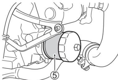
5. 用尺寸適當的鈴木“帽式”濾清器工具或者“帶式”濾清器工具逆時針旋動機油濾清器⑤，將其拆下。
