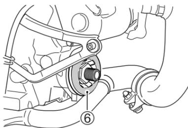
6. 用乾淨的抹布將引擎的機油濾清器安裝表面⑥擦拭乾淨。
