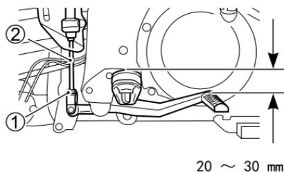
1. 放鬆螺帽 ①，轉動頂桿 ② 使踏板移動到腳踏面下方 20 ~ 30 mm 的位置。
