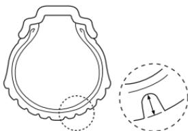
請在每次騎乘前檢查輪胎狀況。若輪胎上有割痕或裂痕等明顯損傷，或前輪的胎紋深度低於 1.6 mm，後輪的胎紋深度低於 2.0 mm，應更換輪胎。
