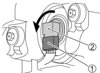
1. 斷開耦合器 ①。將燈座 ② 逆時針轉動並拆下。
