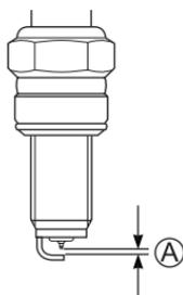
以線型試探計來測量火星塞間隙 (A)。標準的火星塞間隙為 0.8 ~ 0.9 mm。若測到的火星塞間隙超出標準範圍，請換成新的火星塞。
