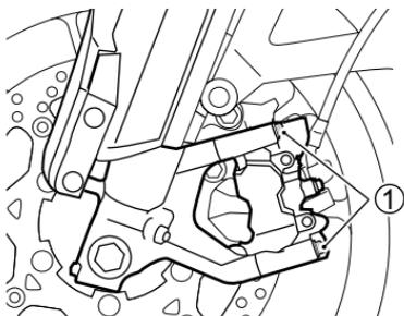
3. 卸下剎車夾鉗上的兩個固定螺栓 ①，將前叉上的兩個剎車夾鉗拆下。
