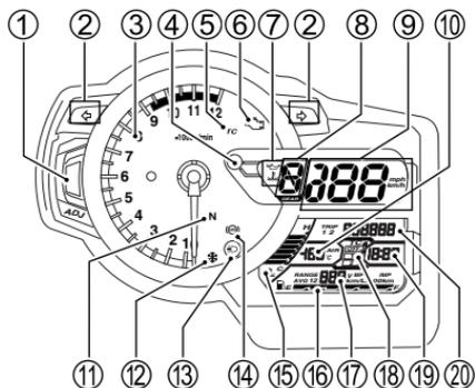
當點火開關處於“ON”（開）位置時，故障指示燈 ⑥、凍結指示燈 ⑫、引擎冷卻液溫度指示燈 / 機油壓力指示燈 ④、ABS 指示燈 ⑭、循跡控制指示燈 ⑮、液晶顯示幕和轉速計指針會按以下方式工作。
