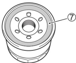
7. 在新的機油濾清器橡膠墊片⑦上塗抹少量的機油。
