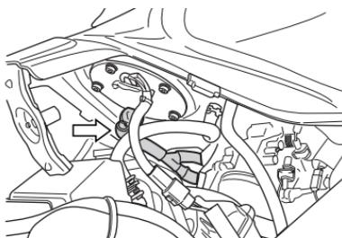
檢查燃油軟管是否損壞或漏油。若發現任何損壞，應更換燃油軟管。
