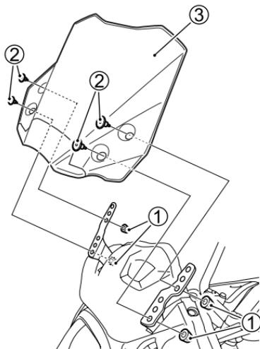
1. 拆下保護蓋 ① 和螺栓 ②，然後拆下擋風玻璃 ③。
