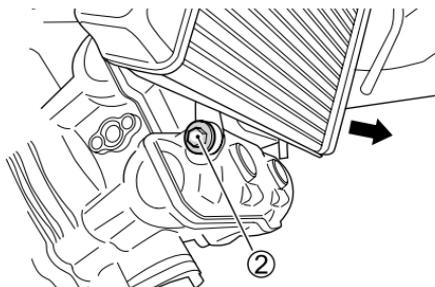
2. 拆下散熱器安裝螺栓 ② 並將散熱器朝前滑動。
