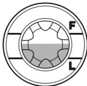
3. 將機車保持垂直，並透過位於引擎右側的機油油位檢查窗檢查機油油位。
