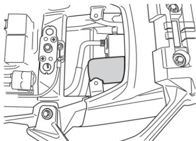
本機車提供一套工具包，該工具包放置於座墊下方。
