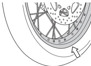
檢查輪圈是否受損，如破裂、變形或彎曲。
