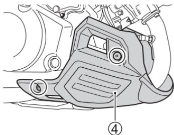
4. 拆下左右螺栓，然後拆除下整流罩④。
