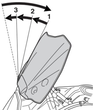
註：在調整好擋風玻璃角度後，確認左右兩側的鎖定裝置都固定在相同位置。
