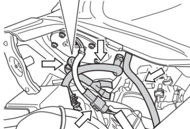
2. 拆卸軟管和耦合器。
