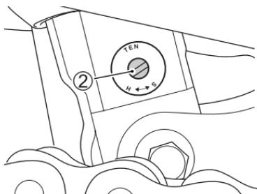
反彈減震力調節器 ② 位於後懸吊減震元件下方。若要調整減震力，請先將調節器設至標準設定，然後調整到想要的位置。
