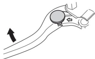
轉把和離合器拉桿之間的距離可分 4 個階段調節。若要變更其位置，請將離合器拉桿朝前推，然後將調節器轉到所需位置。改變離合器拉桿位置時請務必讓調節器停留在適當的位置上。離合器拉桿軸銷上的凸起部分應嵌入調節器上的凹陷處。本型機車出廠時調節器位於位置 2 上。
