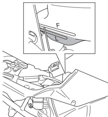
拆下座墊以便檢查冷卻液液位。冷卻液量應隨時保持在儲存槽的刻線“F”（滿）和“L”（低）之間。每次騎乘前，應在機車直立狀態下檢查液位。若冷卻液液位低於刻線“L”，請按照下列方式添加指定的引擎冷卻液：
