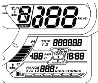
打開點火開關時，液晶顯示幕的所有區塊都會顯示。此時，如果液晶顯示幕僅顯示公里（公里 / 小時），則無法切換到英哩（英哩每小時）指示，因為此儀錶板採用公制單位。
