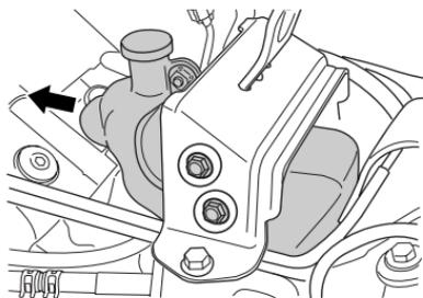
2. 拆下儲存槽安裝螺栓，並將儲存槽向前移動。
