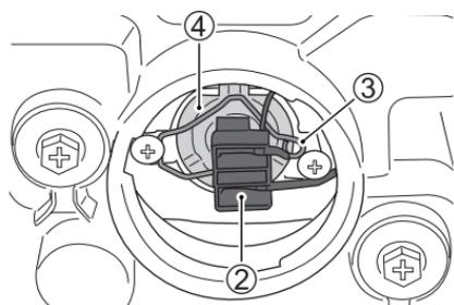
2. 斷開插座 ②。解開燈座彈簧扣 ③，拔出燈泡 ④。
