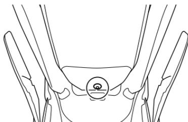
5. 拆下螺栓與緊固器。
