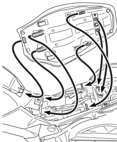
若要重新安裝座墊，請將座墊掛鉤滑入座墊掛鉤固定架中，同時用力推，直至座墊“啪嗒”一聲進入鎖定位置。
