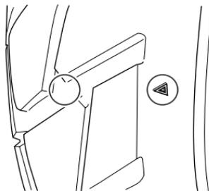
註：“△”標記指出輪胎嵌入磨損指示線的位置。當磨損指示線與路面接觸，表示輪胎已達到磨損限度。
