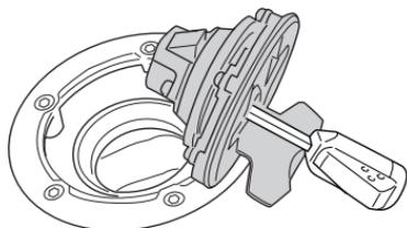
若要打開油箱蓋，請將點火鎖匙插入鎖孔並順時針旋轉。在插入鎖匙的狀況下，以鎖匙拉起並打開油箱蓋。若要關閉油箱蓋，請在鎖匙插入鎖孔的狀態下將油箱蓋緊緊按下。
