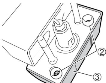
2. 拆下螺絲 ②，並將保護蓋連同燈罩蓋 ③ 一併取出。
