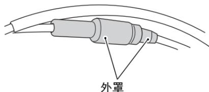
油門線有外罩。確認外罩牢牢固定。在清洗機車時，切勿直接對外罩噴水。如果外罩髒了，請以濕布將外罩上的灰塵擦拭乾淨。
