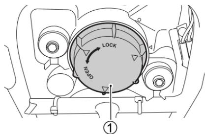
1. 將橡膠蓋 ① 逆時針轉動並拆下。
