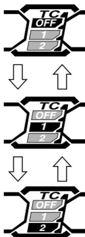
3. 按下循跡控制系統開關 ⑥ 以取消模式選擇。儀錶板中的循跡控制系統顯示幕返回正常顯示模式。
