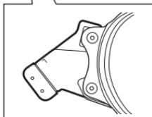
8. 請將左右油箱側保護蓋 ④ 向前滑動以脫離該扣鉤。拆下左右油箱側保護蓋 ④。
