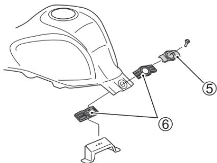
9. 拆下螺栓。拆下支架 ⑤ 和兩個緩衝墊 ⑥。
