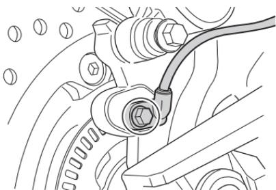
2. 拆下安裝螺栓以卸除後輪速度感知器。
